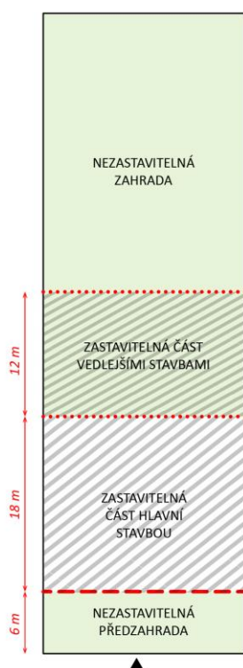
obr. 2 Schéma rozdělení pozemku na zastavitelnou a nezastavitelnou část
